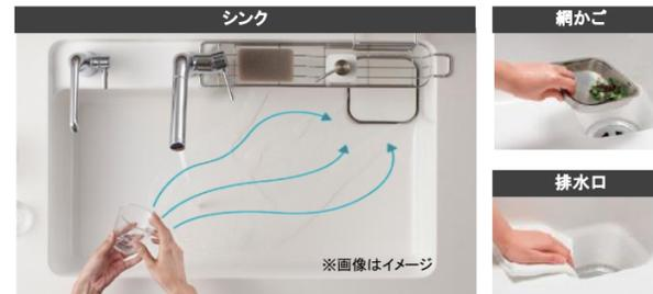
シンクの底に3°の傾斜を設けることで、すべり台をすべるように排水口へと水やごみが流れます。さらに排水口と網かごの形状にも傾斜を持たせ、3つのすべり台の合わせ技でシンク内のきれいを保ちます。
